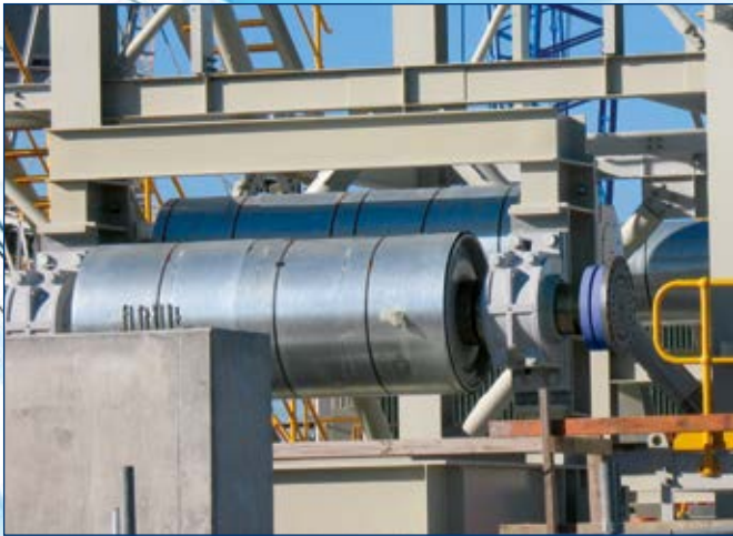
Polea de correa transportadora con anillos de fijación, además de anillo de contracción fijando el acoplamiento de bridas del accionamiento.
