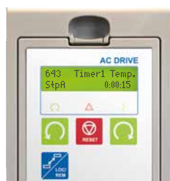
Los bloques de programación incorporados, como temporizadores y comparadores, le permitirán personalizar las funciones.
