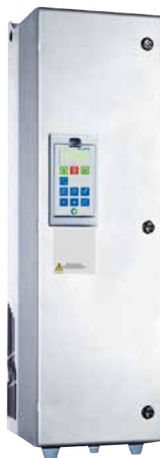
Las unidades compactas montadas en pared de 0,55-132 kW tienen la clasificación IP54, por lo que no es necesario usar armarios y cableados de larga longitud para el motor, con el coste que conllevarían.
